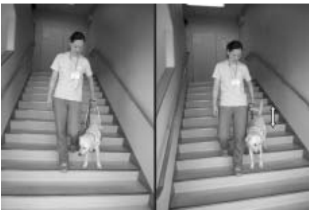
図15 段差（階段）歩行：現用（左） 試作ハーネス（右：ジョイント軸の影響で不評）
