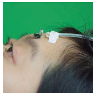
額（ひたい）の動きを 検知する光センサースイッチ
