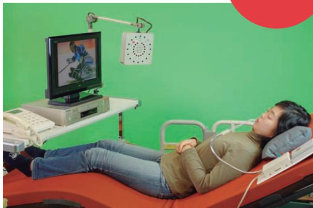
テレビ・DVD・エアコン・照明など、身の回りの電化製品をまとめてコントロールできる「賢いリモコン」が環境制御装置（ECS：Environmental Control System）です。
