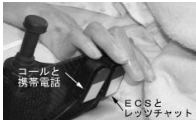
図7 右手に配置した2個のマイクロライトスイッチ
