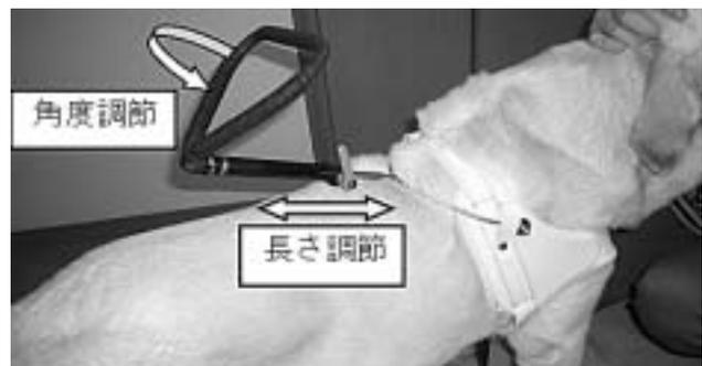
図2 試作した実験用ハーネス
