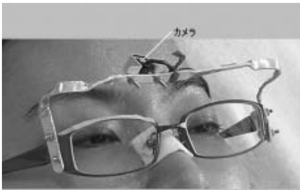
図2 眼鏡フレームにセットしたカメラ
