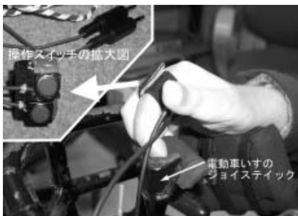
図2 ジョイスティック上での2入力操作
