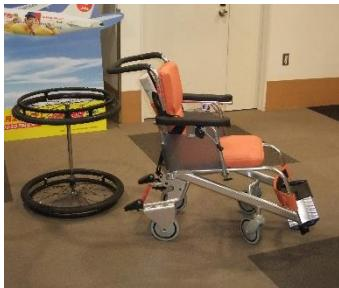
【写真4 車輪が外れる車椅子】
